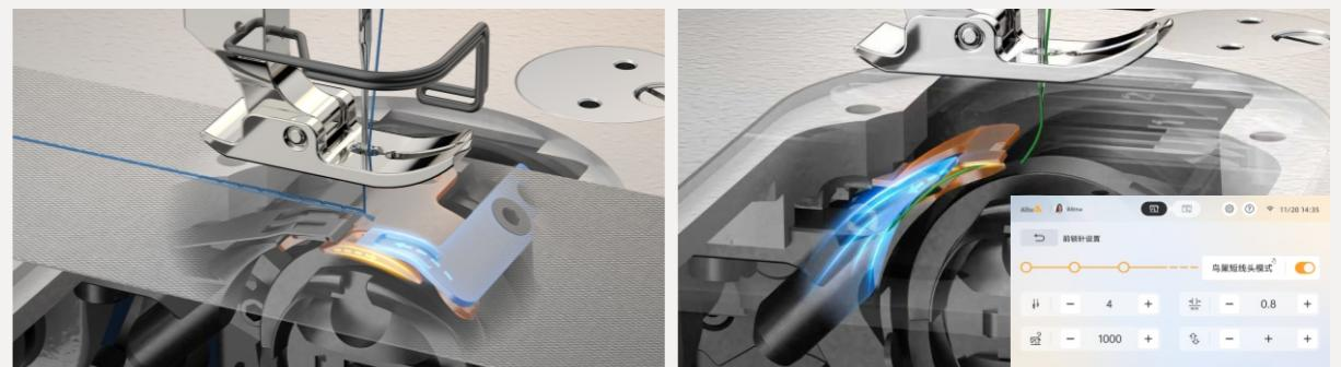
双动刀剪线，剪线后线头≤3mm。
