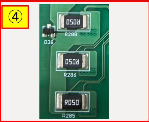
④使用万用表电阻档测试采样电阻R285 (50mΩ)、R286 (50mΩ)、R288 (50mΩ)是否正常，若不正常则进行更换。
