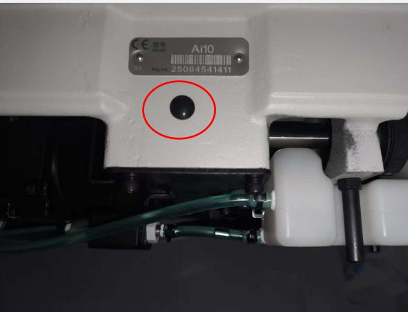
红圈齿轮箱位置严禁加油，否则会出现严重漏油现象！！！
