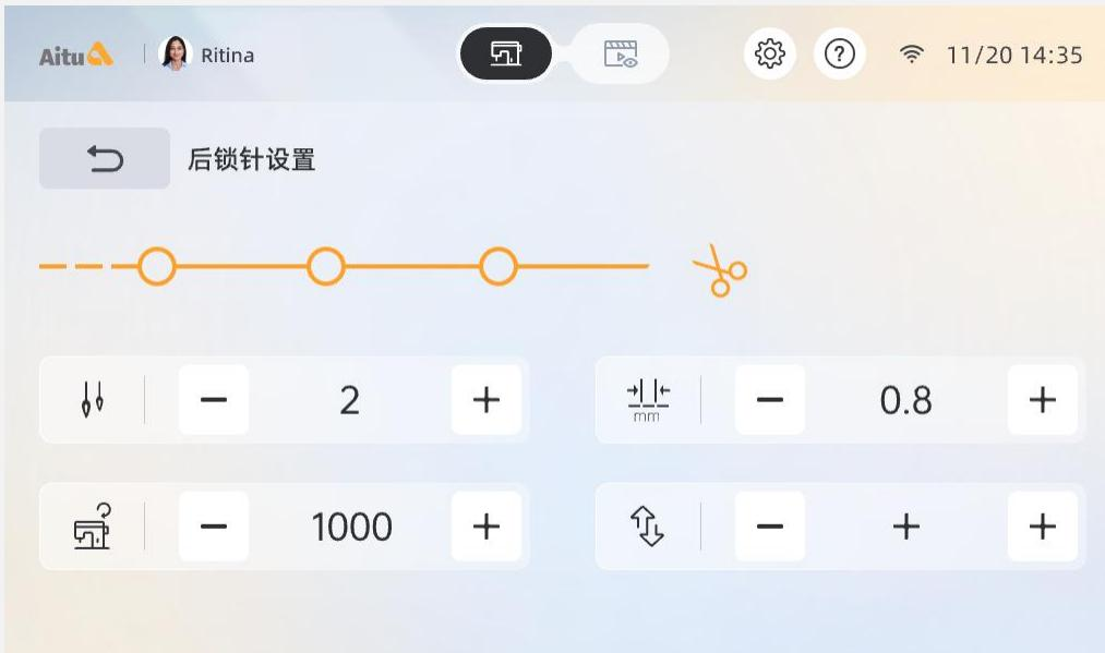
在参数设置界面点击“后锁针设置”，进入后锁针设置界面，点击“+”“-”键调节相关的参数，参数修改后自动保存。
