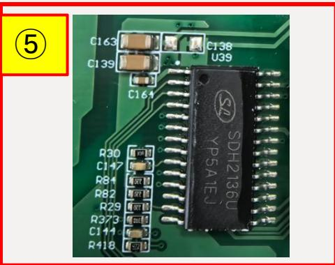
⑤测试驱动芯片U39周围R129、R30、R82、R84电阻，如电阻不正常则进行更换；测试U39的8脚对3.3V阻抗（正常1K），9脚对PGND阻抗（正常为220R左右），如阻抗不正常，先测试电阻R371（正常1K），电阻不正常则更换电阻，电阻正常，先尝试更换U39，如更换后依旧故障，则考虑更换单片机。
