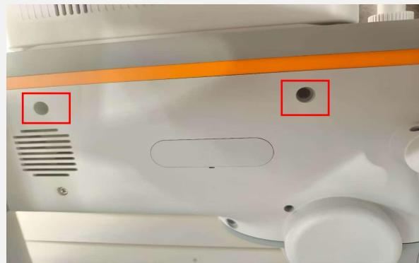
紧固操作屏内六角螺丝 (3.0毫米)
