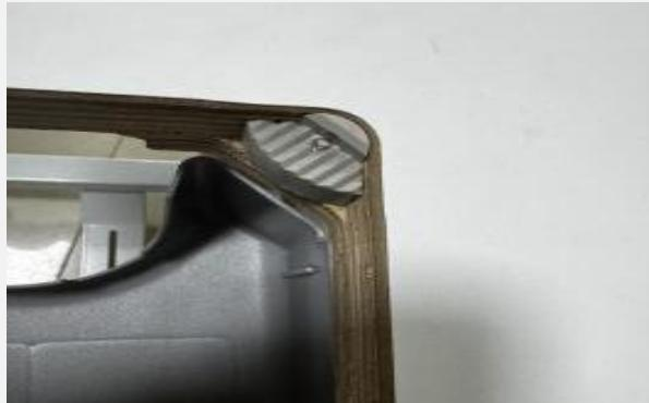
用钉子加固机头橡胶垫
