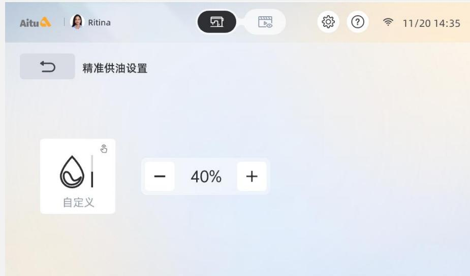
在参数设置界面点击“精准供油设置”，进入精准供油设置，点击图标切换供油方式，在自定义模式下，使用“+”“-”键调节相关的参数，参数修改后自动保存；
