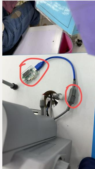
第十一步：机器关机后，将“电控工具”与机器连接。机器开机后会自动升级。
