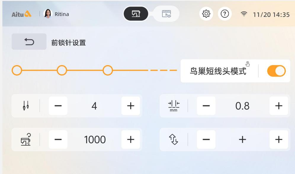
在参数设置界面点击“前锁针设置”，进入前锁针设置界面，点击“+”“-”键调节相关的参数，参数修改后自动保存。
