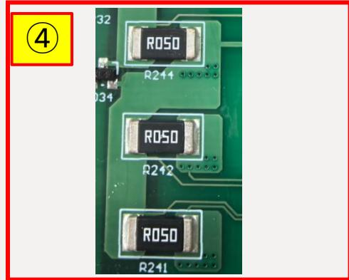
④使用万用表电阻档测试采样电阻R241（50mΩ）、R242（50mΩ）、R244（50mΩ）是否正常，若不正常则进行更换。
