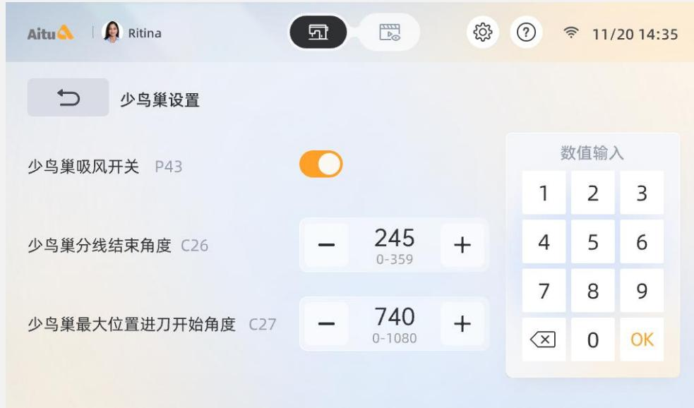
在参数设置界面点击“少鸟巢吸风设置”，进入少鸟巢设置，点击开关少鸟巢吸风开启或关闭点击“+”“-”键调节相关的参数，参数修改后自动保存；
