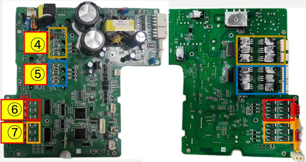
④检查主轴驱动采样电阻R367、R368、R370是否损坏，若损坏则需更换。检查主轴驱动电路IGBT Q24-Q29是否有炸裂痕迹，有则更换相应IGBT，并检测驱动回路相关元器件。
