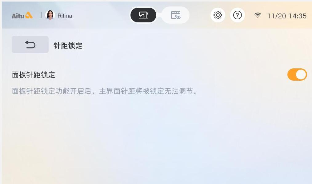
1. 在参数设置界面点击“面板针距锁定功能”，进入面板针距锁定功能界面，点击图标面板针距锁定功能开启或关闭。
