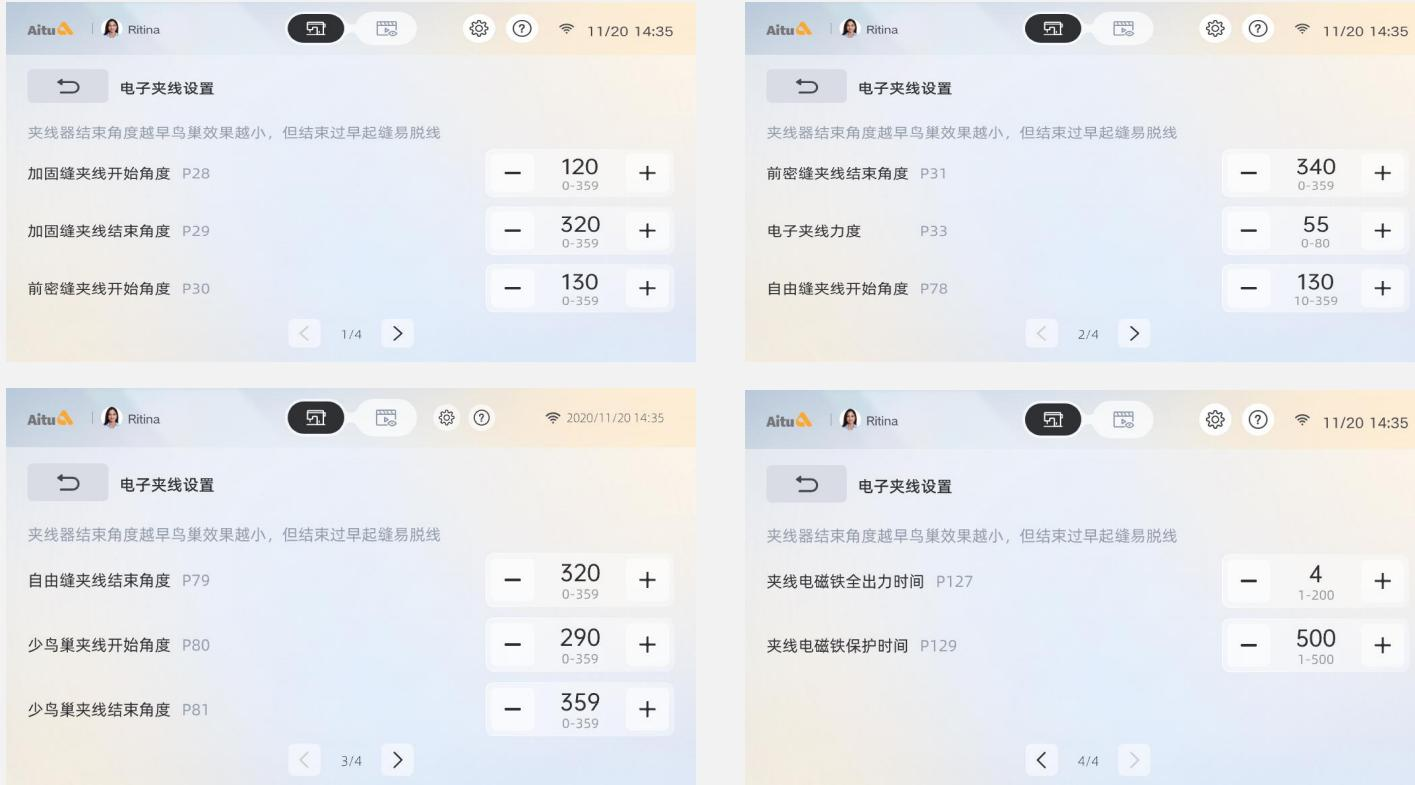
参数设置界面点击“电子夹线设置”，进入电子夹线设置界面共四页。在电子夹线设置界面，点击“+”“-”键调节相关的参数，参数修改后自动保存。
