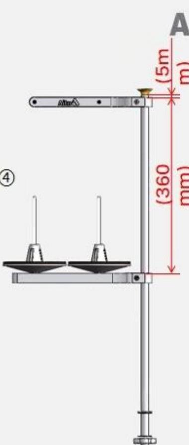
依次将上线架、下线架插入线杆、拧紧螺丝，并安装防护塞
