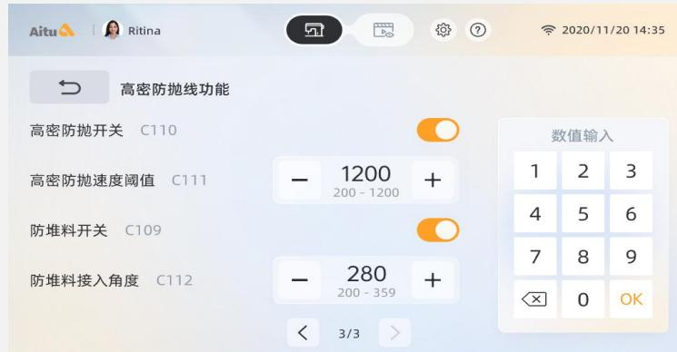
在参数设置界面点击“剪线设置”，进入剪线设置，点击“+”“-”键调节相关的参数，参数修改后自动保存，小键盘输入数值后按OK键保存。;
